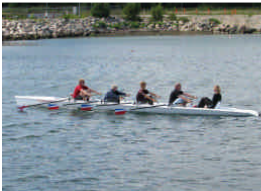
Roerne sidder forholdsvis højt i båden, men samtidig bevirker bådens skrogform at at bådens dybdegang er forholdsvis lille. Båden ligger relativt højt på vandet, og det hele sammenlagt, giver en hurtig båd på vandet trods bådens vægt på kg. 140
